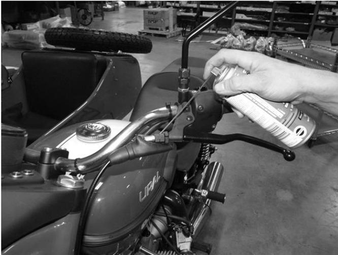
Все тросы, включая трос сцепления, спидометра, дросселя и стояночного тормоза должны смазываться смазкой для тросов или маслом WD-40 в соответствии с интервалами обслуживания. Вы также должны смазывать тросы до и после длительного хранения мотоцикла и/или после езды по бездорожью.
