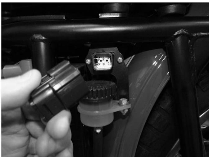
Порт данных электронного блока управления расположен за левой боковой панелью. Этот порт предназначен
